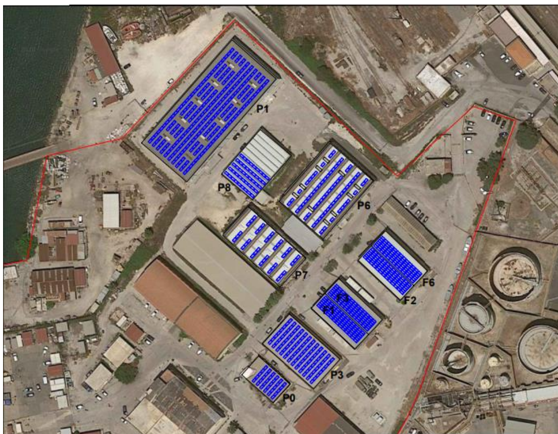
Fig. 3. Stralcio planimetrico con evidenza delle superfici impegnate dai moduli fotovoltaici.
